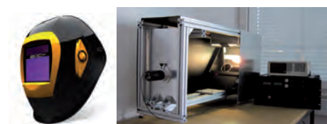
Slika 18: Varilska čelada z aktivnim LCD zaščitnim filtrom, ki jo proizvaja Balder; d. o. o., ki je odcepljeno podjetje odseka F5 na IJS. Desna slika kaže standardni svetlobni izvir za merjenje svetlobnih karakteristik varilskih zaščitnih filtrov.
